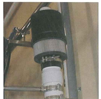
写真4 センチネル社の調圧器
