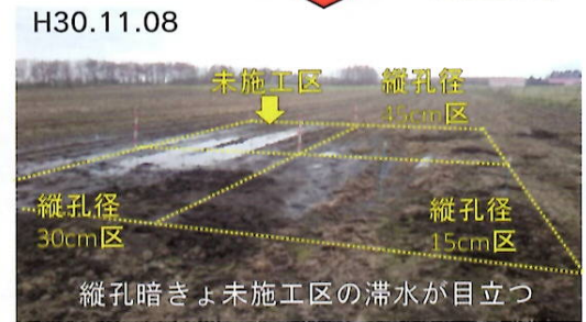
写真3 試験区の滞水状況の推移
