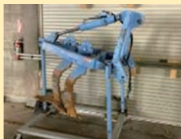
写真(左) 穿孔暗渠機
