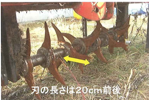
写真5 表層穿孔(せんこう)タイプ。写真はエアレーター
