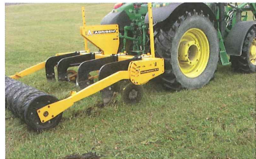
写真2 草地用サブソイラーによる切断の様子
