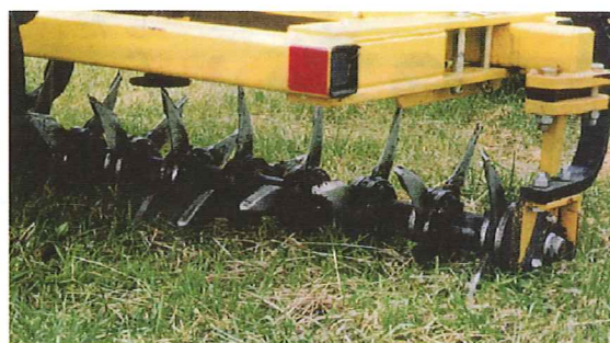
写真1 リノベータ (刃が土中に入り込んだ状態)
