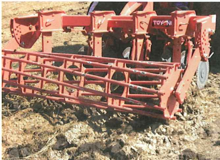
ダブルソイラによる心土破碎
