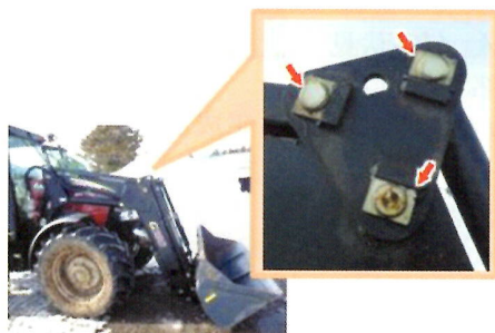
写真2 ローダーアームのピン（一部）アームの内側からグリスを注入。簡単な作業なので、まめに実施して欲しい（メーカーメカニック談）
